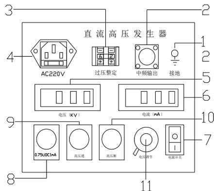
1. 控制箱接地端子：控制箱接地端子与倍压筒接地端子及试品接地联接为一点后
