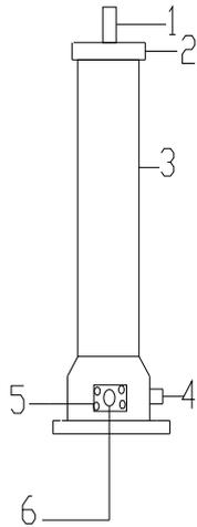
1. 高压引出接线柱（可连接微安表或限流电阻）
