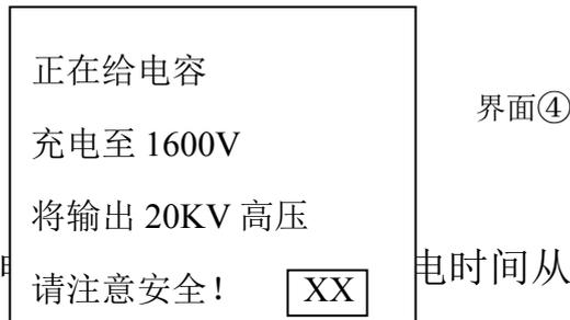
其中XX表示充电时间从 60 秒降到 0 秒后，仪器停止充电，随即仪器输出脉冲高压并同时输出脉冲磁场电压。随后屏幕上会显示被测真空开关的真空度的值，测量结束后仪器将显示界面（2.3E-03Pa 即为 0.0023Pa）。
